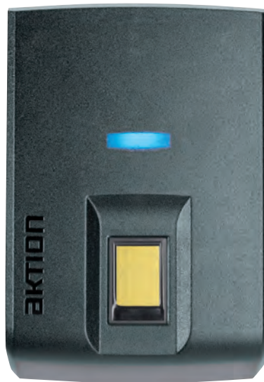
AXR-500 je snímač otisků a RFID karet.
