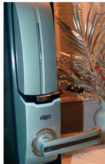
Zámek FPL-700, pod horním krytem je snímač a klávesnice.
